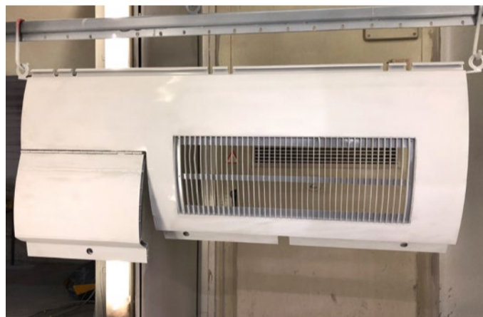
Die grundierte Klappe ist für die Decklackierung vorbereitet. Die Pulverbeschichtung der Klappen ist dabei optimal auf die Eigenschaften des Nasslacksystems abgestimmt.
