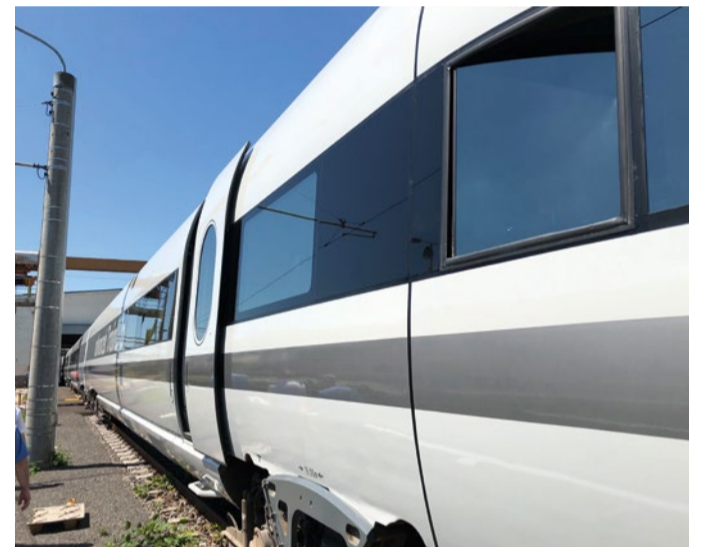
Die eingesetzten Lacksysteme entwickelte FreiLacke sowohl für die Erstbeschichtung als auch für Revisionslackierungen.
